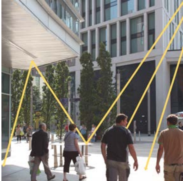
Figur 3. Ljusa material har högre albedo än mörka material, vilket innebär att ljusa material har en bättre förmåga att reflektera solens strålning tillbaka ut mot atmosfären dagtid. Samtidigt kan strålningen tillbaka mot rymden hindras beroende på omgivningens rumsliga geometri och gestaltning. Utstickande strukturer och komplexa vinklar kan bidra till multipla reflektioner. Det gör att den strålning som skulle kunna reflekteras tillbaka mot rymden vid en hög himmelsfaktor (sky view factor) i stället kan reflekteras till ett mörkare material där den till största delen absorberas och lagras som värme.
