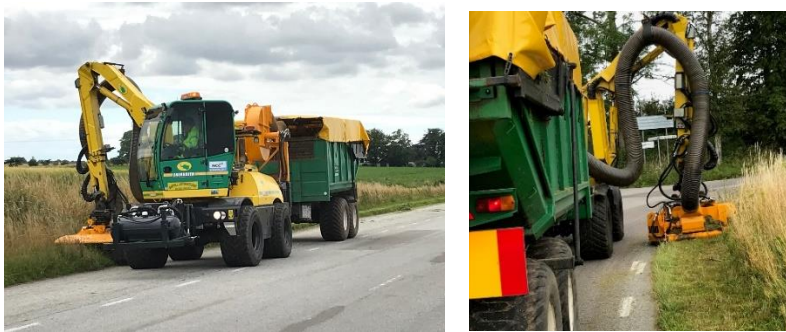
Figur 2 och Figur 3. Rotorslätter (Herder Ecological Mower) för skonsammare avslagning av väggkantsvegetation. Foto: Sven-Erik Svensson.
