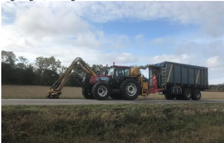
Figur 1. Traktordragen slagslätteraggreat (Herder) för avslagning och uppsamling av vägkantsvegetation på Öland. Foto: Sven-Erik Svensson.
