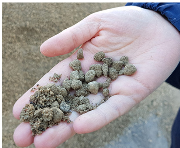
Bild som visar ett av de filtermaterial, utvecklat av LTU, som används i biofiltren längs Neptunigatan. Foto: Helena Norlander.
